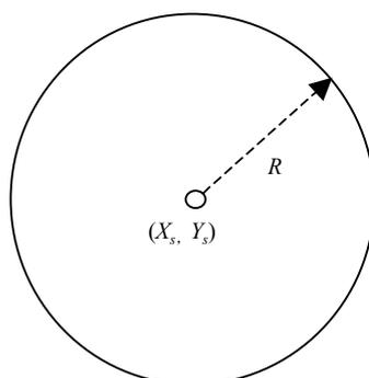
注：(X<sub>s</sub>, Y<sub>s</sub>) 为圆弧弧心坐标; R 为圆弧半径
