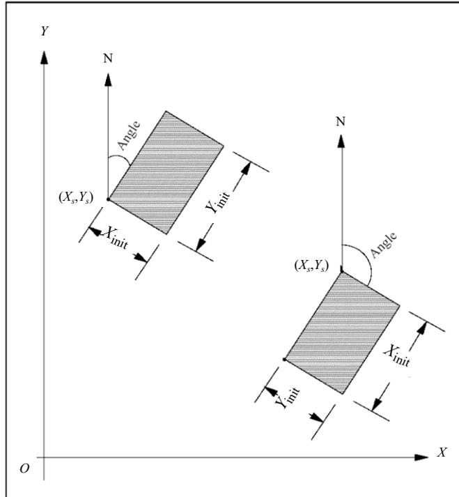
注：  $(X_s, Y_s)$  为面源的起始点坐标； Angle 为面源 Y 方向的边长与正北方向的夹角（逆时针方向）；
