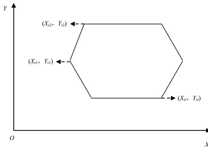
注：  $(X_{s1}, Y_{s1})$ 、 $(X_{s2}, Y_{s2})$ 、 $(X_{si}, Y_{si})$  为多边形面源顶点坐标
